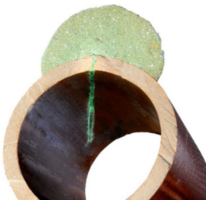
LV 4: Injektionsverfahren (nicht begehbare Bereich) | Quelle: www.janssen-umwelttechnik.de
