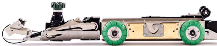
LV 1: Roboterfahren (Fräsen, Spachteln, Verpressen) | Quelle: www.pipetronics.de
